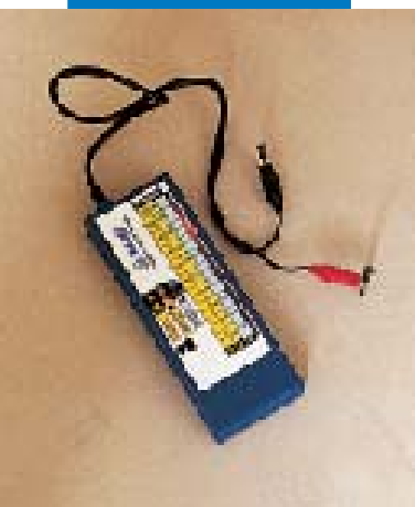
Mesure de l'humidité de la chape Mapecem avec hygromètre électrique MAPEI
