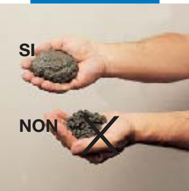
Détermination de la consistance adéquate du mélange Mapecem
