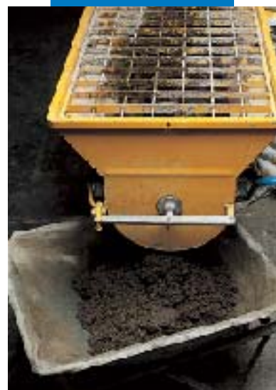
Malaxage de Mapecem avec un malaxeur horizontal
