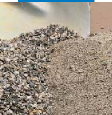
Granulats pour chape Mapecem sable de 0 à 4 mm - gravillon de 4 à 8 mm
